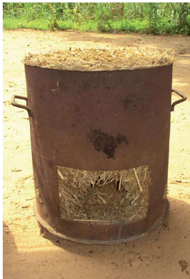
Pec z použitých dílů na spalování prosných slupek
